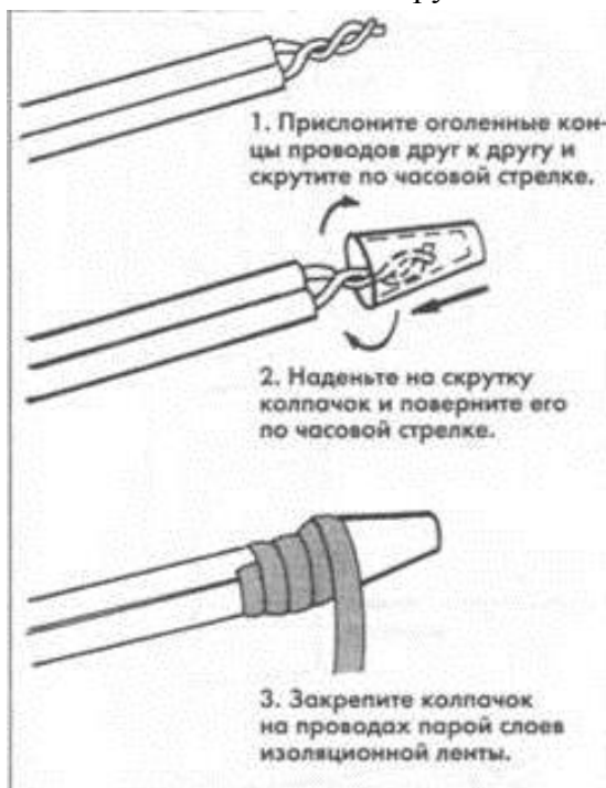
Рисунок 2 – Соединение жил кабеля
